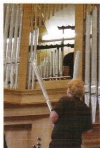
●パイプの組み込み
